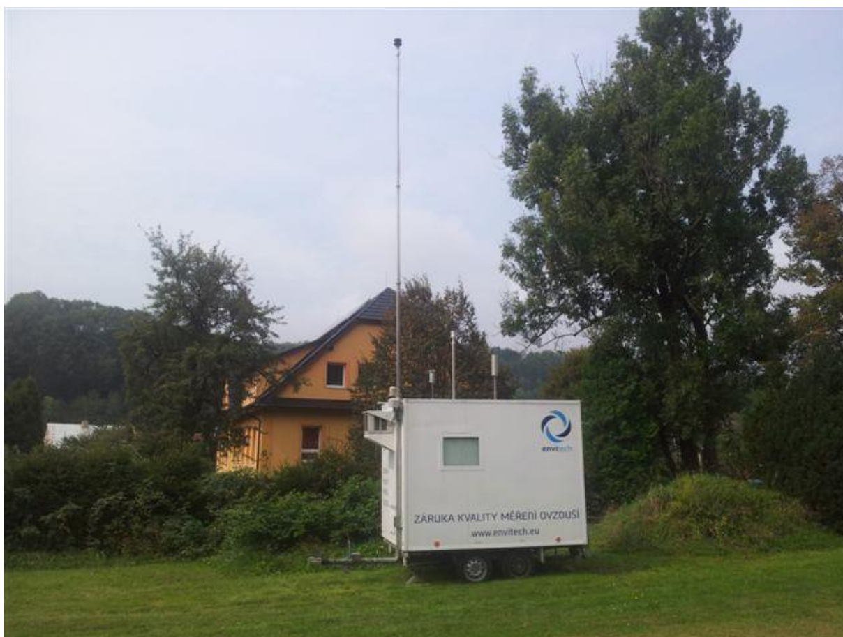
Obr. 4 - Stanice imisního monitoringu v Zubří
