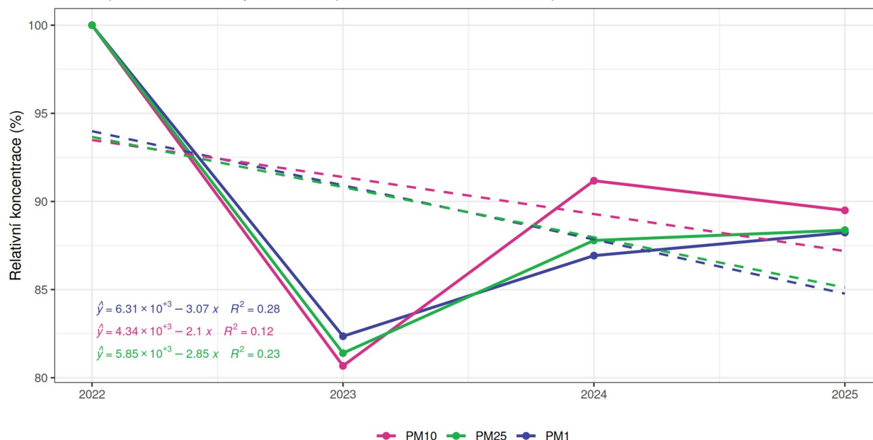
Obr. 14: Vývoj relativních ročních koncentrací PM proti počátečnímu roku měření (2022), Rožnov pod Radhoštěm, rok 2025
